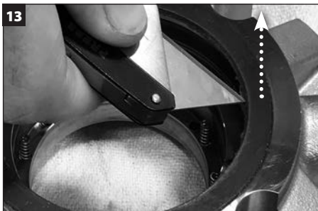
Die Dichtraum-Flachdichtung aus dem Dichtungsflansch ausbauen und entsorgen.
